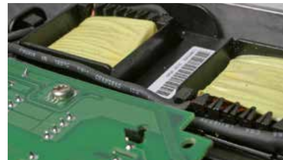
Eingebaute Netzdrosseln, wie hier die Zwischenkreisdrosseln reduzieren wirkungsvoll die Oberschwingungen.
