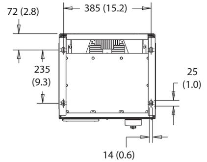
Abbildung 8.60 Rückansicht der Bauform D8h
