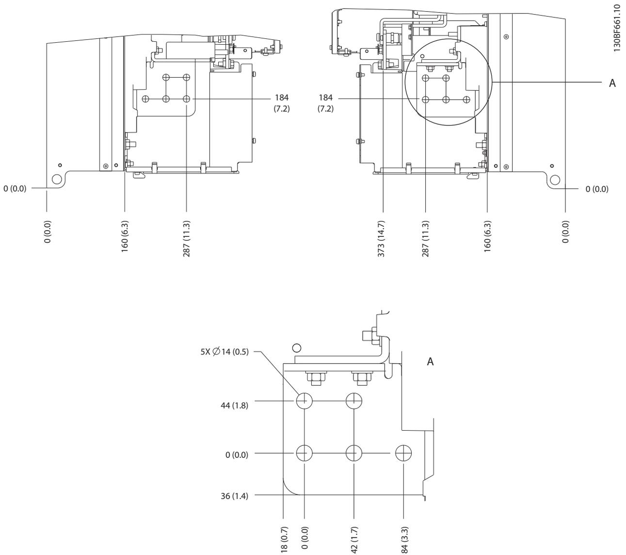
Abbildung 8.87 Abmessungen der Motor-, Netz- und Erdungsanschlussklemmen für E3h (Seitenansichten)
