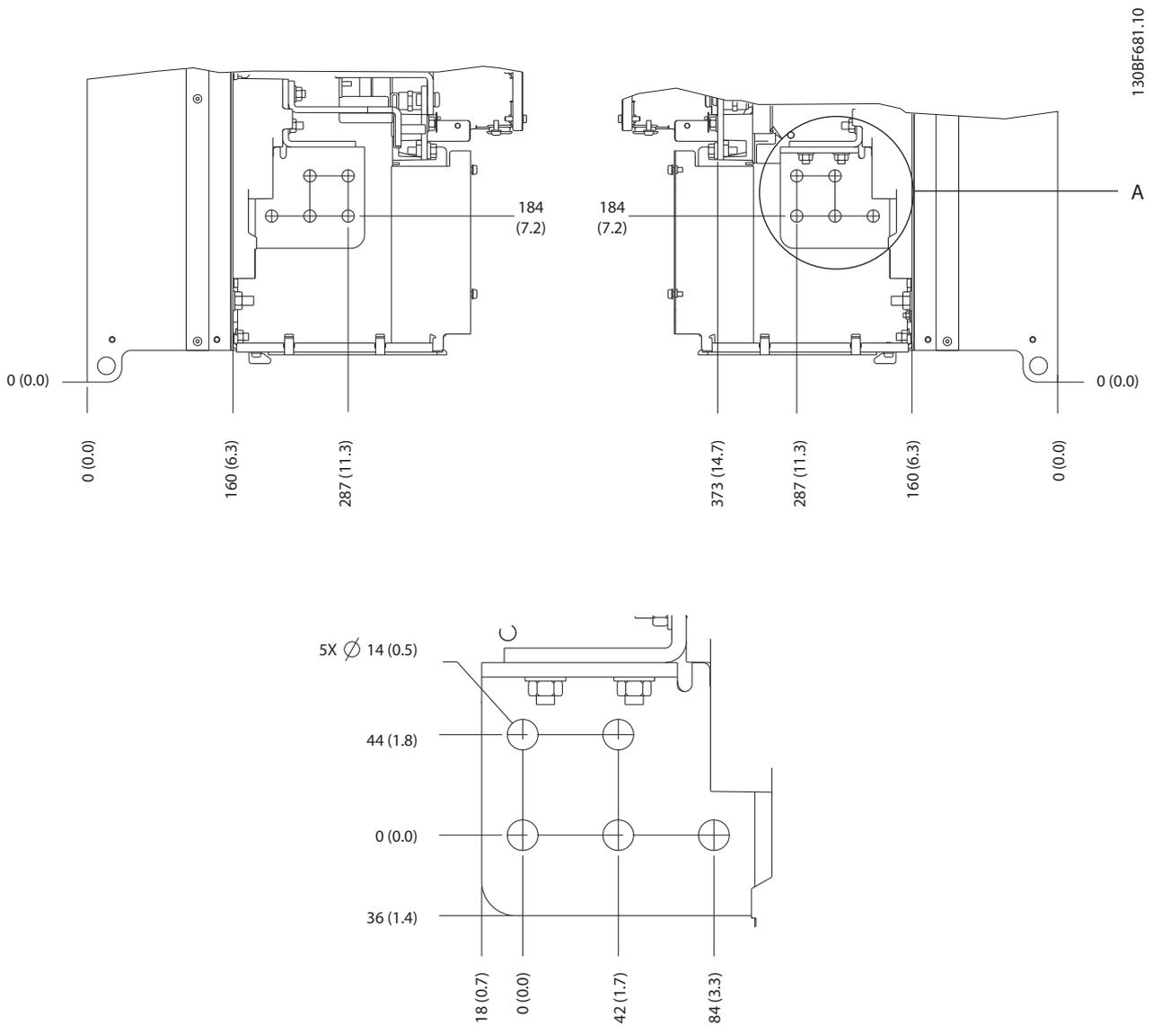
Abbildung 8.94 Abmessungen der Motor-, Netz- und Erdungsanschlussklemmen für E4h (Seitenansichten)
