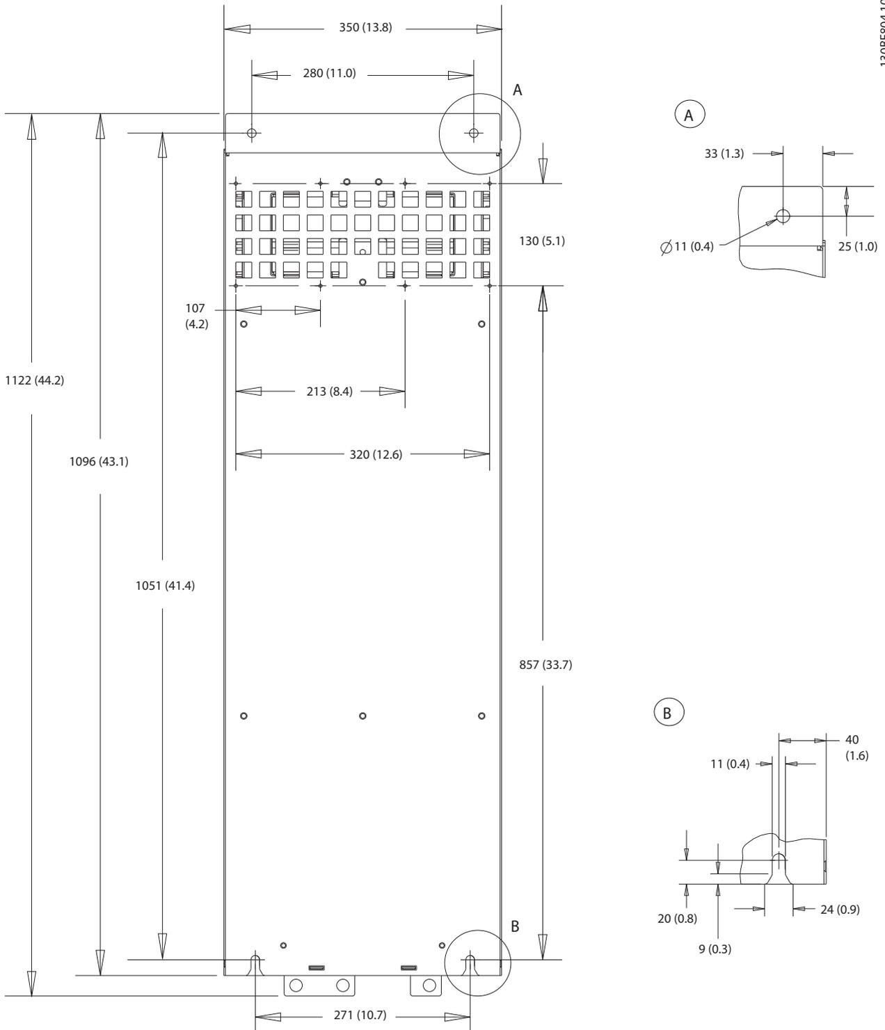
Abbildung 8.22 Rückseitige Abmessungen für die Bauform D4h
