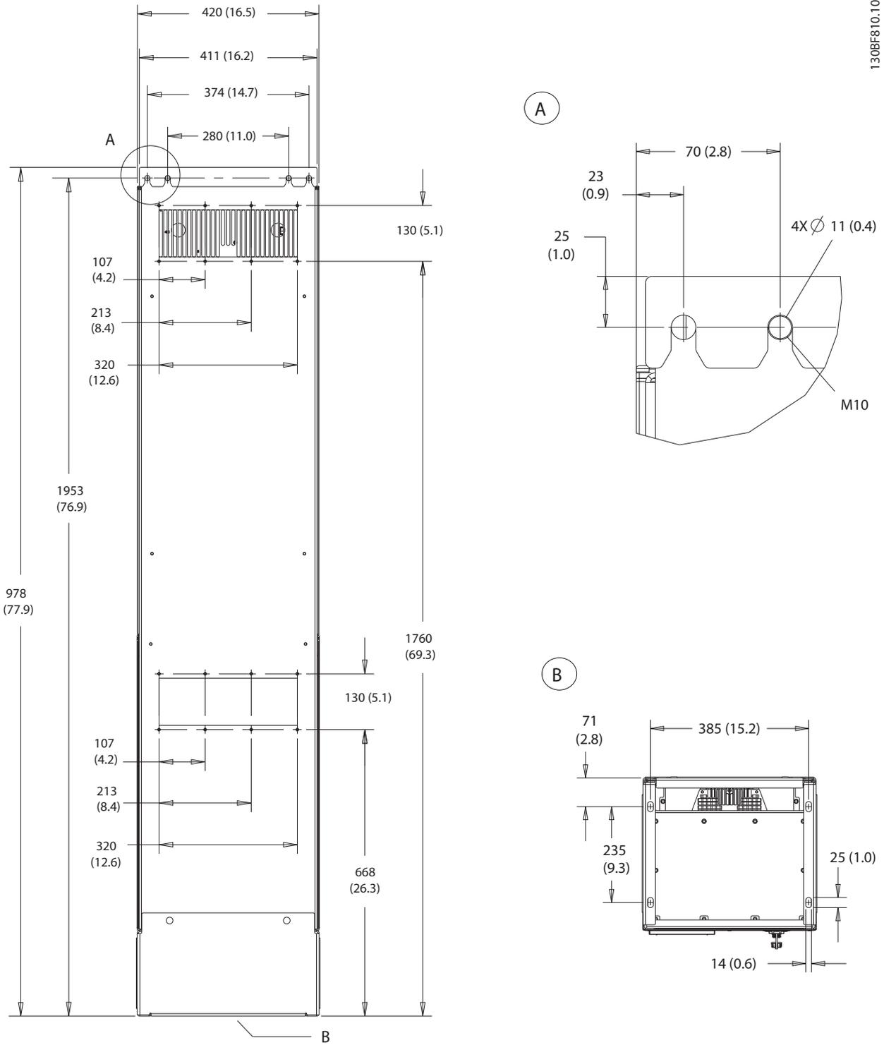
Abbildung 8.49 Rückansicht der Bauform D7h
