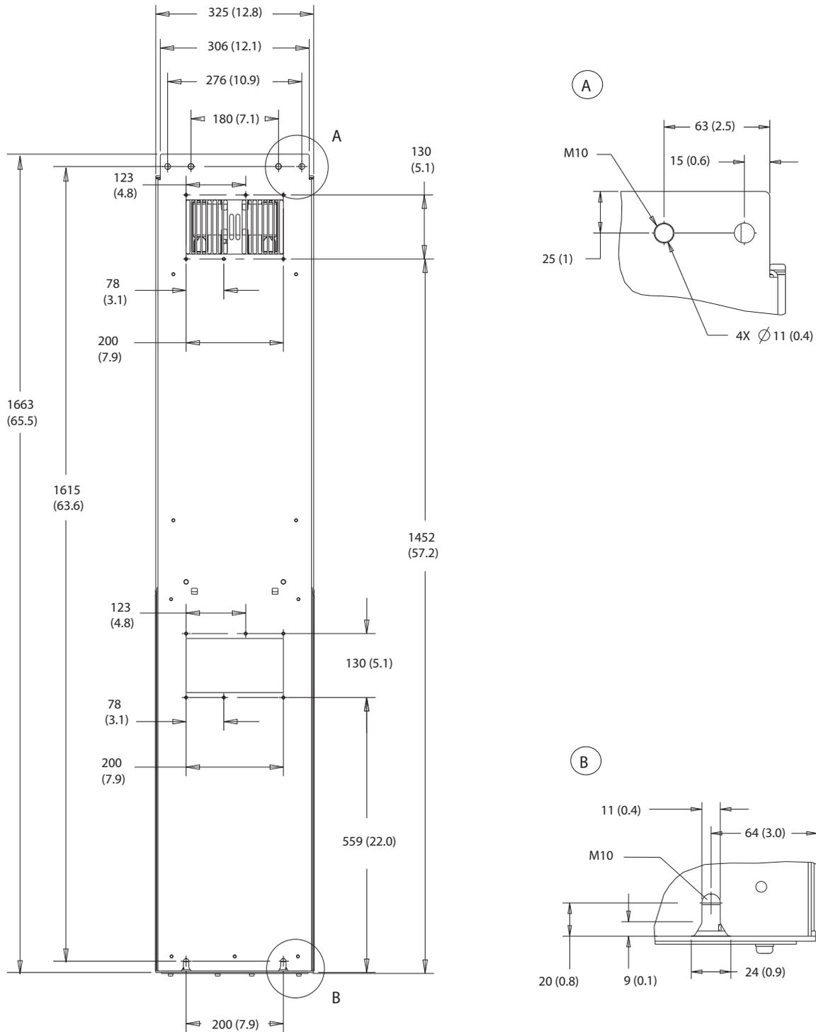
Abbildung 8.37 Rückansicht D6h
