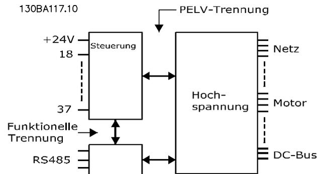
Abbildung 7.1 PELV-Isolierung
