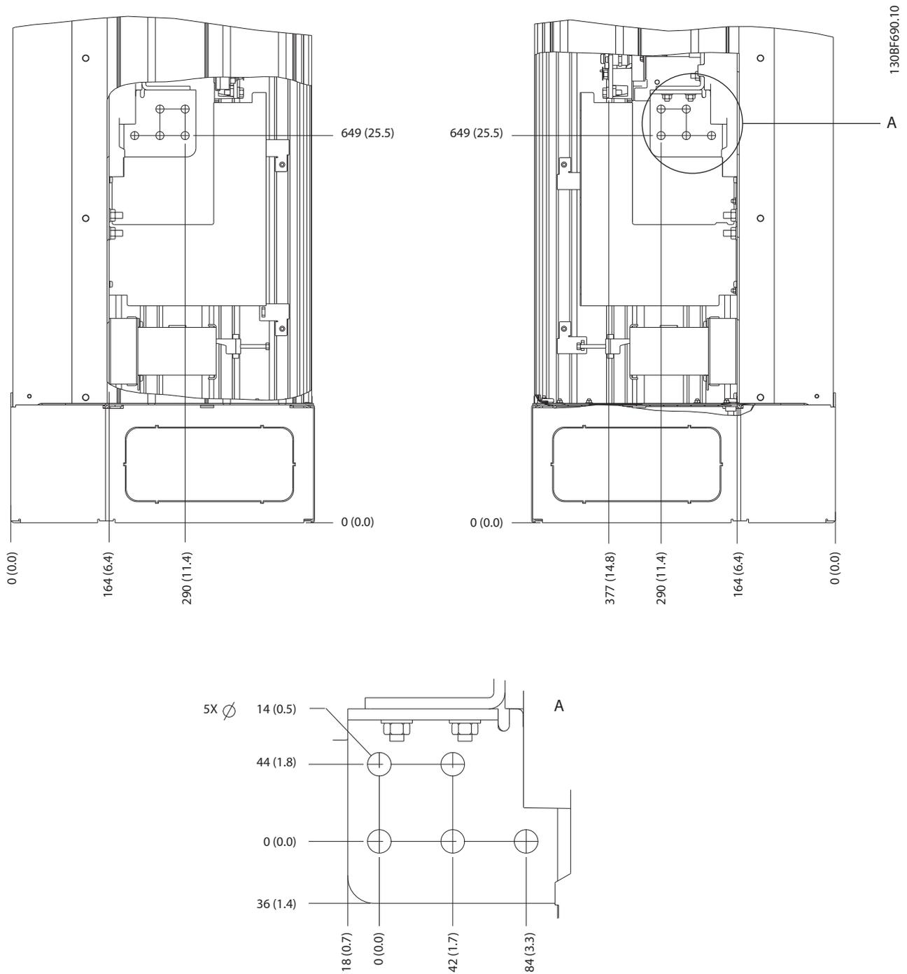
Abbildung 8.81 E2h-Klemmenabmessungen (Seitenansichten)
