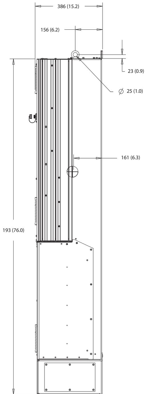
Abbildung 8.48 Seitenansicht der Baumform D7h
