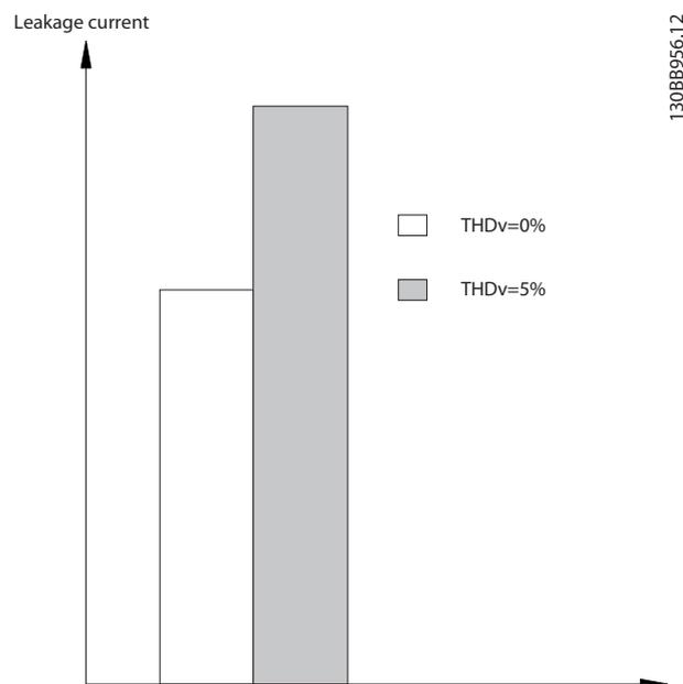
Abbildung 10.13 Die Netzverzerrung beeinflusst den Ableitstrom
