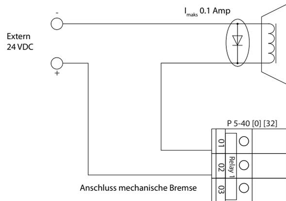
Abbildung 12.8 Anschlusskonfiguration für Drehmoment und Stoppgrenze
