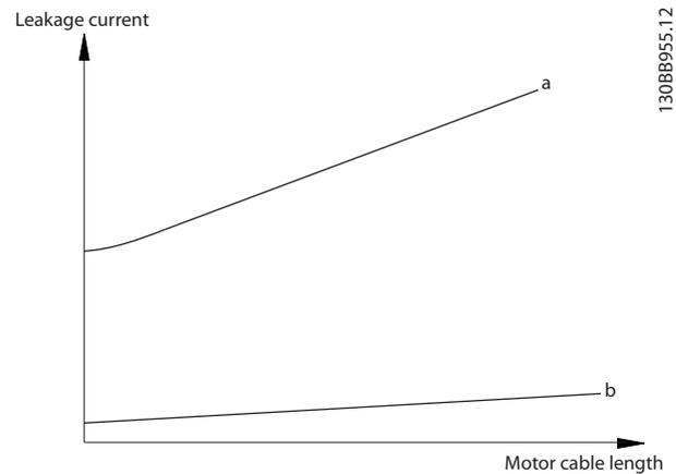
Abbildung 10.12 Einfluss von Motorkabellänge und Leistungsgröße auf den Ableitstrom. Leistungsgröße a > Leistungsgröße b.
