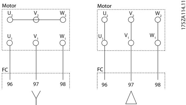
Abbildung 10.3 Motorkabelanschluss
