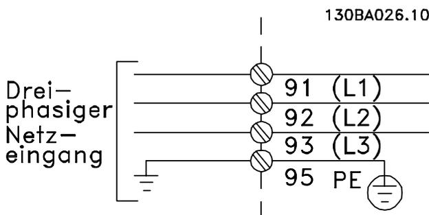
Abbildung 10.2 Leistungskabelanschlüsse
