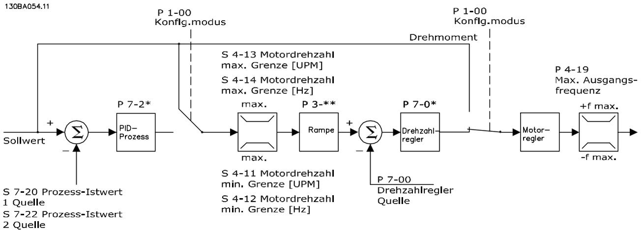
Abbildung 11.10 Regelungsstruktur bei Konfiguration mit Fluxvektor mit Geber
