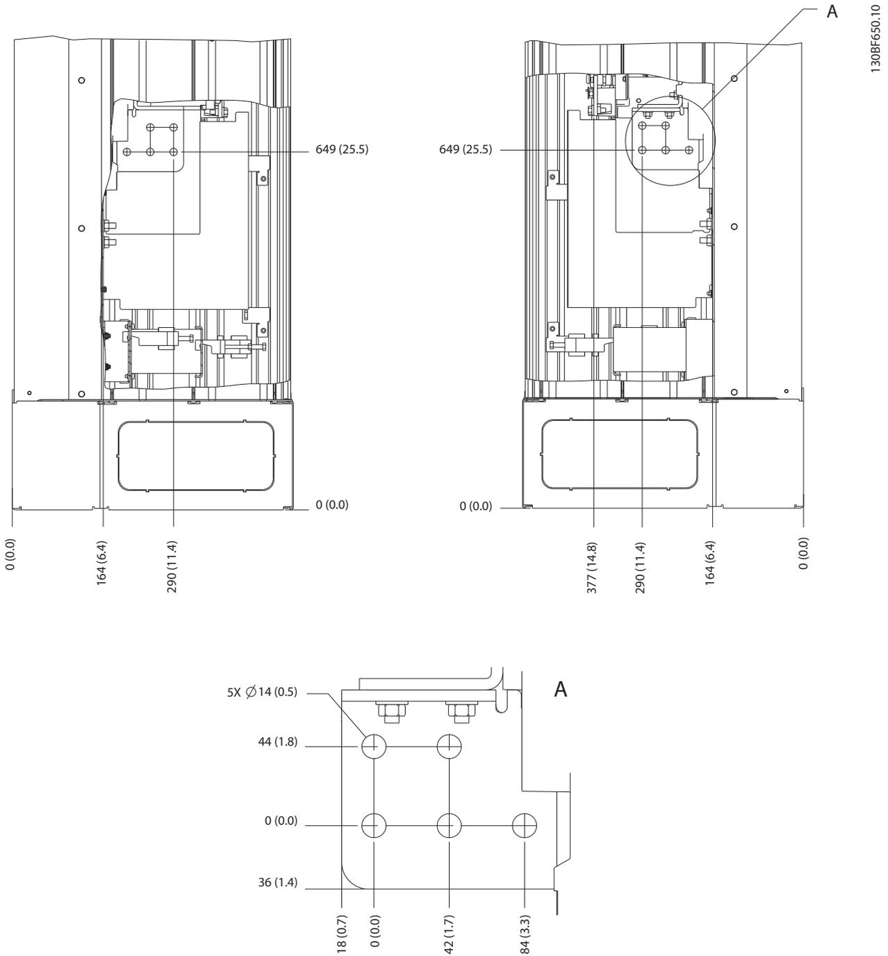
Abbildung 8.75 E1h-Klemmenabmessungen (Seitenansichten)
