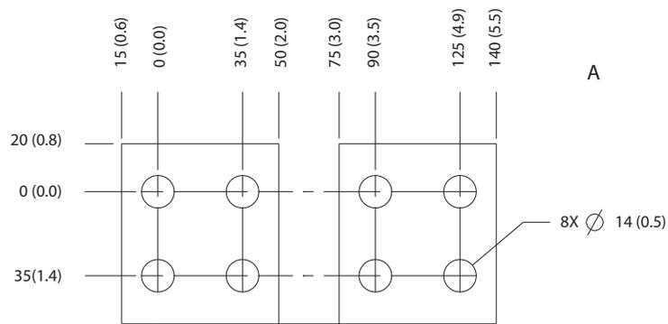
Abbildung 8.88 Abmessungen der Zwischenkreiskopplungsklemmen/Anschlüsse für Rückspeiseeinheiten für E3h
