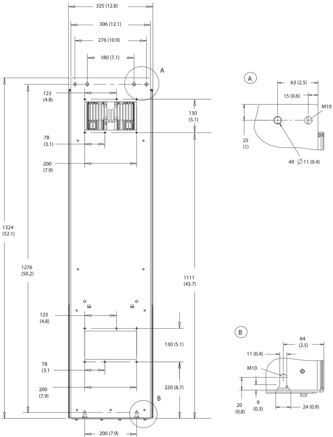
Abbildung 8.27 Rückansicht D5h
