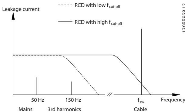
Abbildung 10.14 Hauptbeitragsfaktoren zum Ableitstrom
