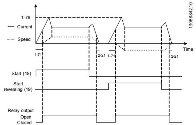
Abbildung 12.5 Mechanische Bremssteuerung
