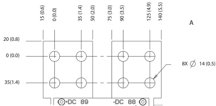
Abbildung 8.95 Abmessungen der Zwischenkreiskopplungsklemmen/Anschlüsse für Rückspeiseeinheiten für E4h
